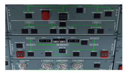
Vérifiez que la tension des batteries est supérieure à 25.5V.
